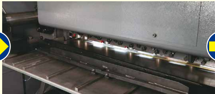
BG (バックゲージ) が後退し、サポートが上がります
